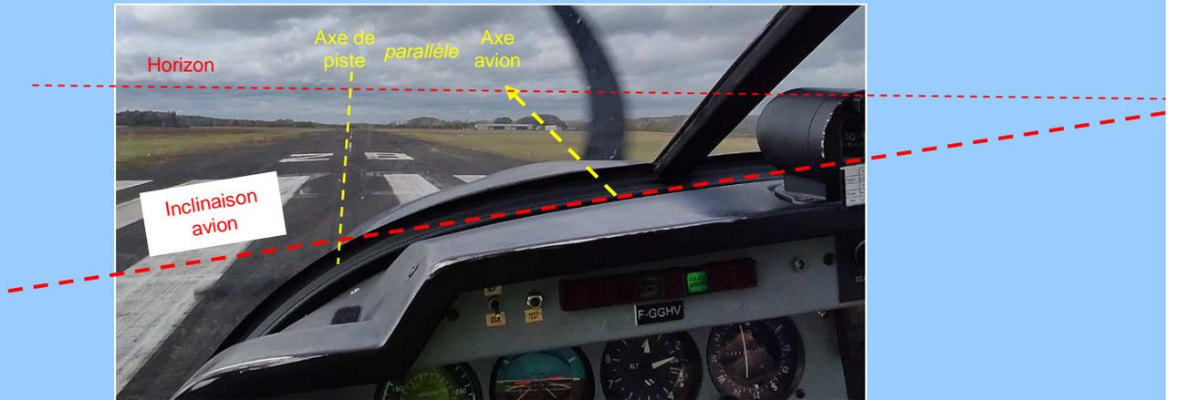
A l'arrondi, **d'abord on décroche** l'avion en mettant du pied à droite pour remettre l'axe avion parallèle à l'axe de piste, **puis** on utilise le **gauchissement pour rester au milieu de la piste** en inclinant l'avion à gauche (plus ou moins selon la force du vent) dès que l'avion commence à dériver vers la droite (tout en gardant et en dosant l'action au pied). On se met donc en légère glissade, et on se pose sur une roue (la roue côté vent, l'autre roue se posera dans la foulée).
