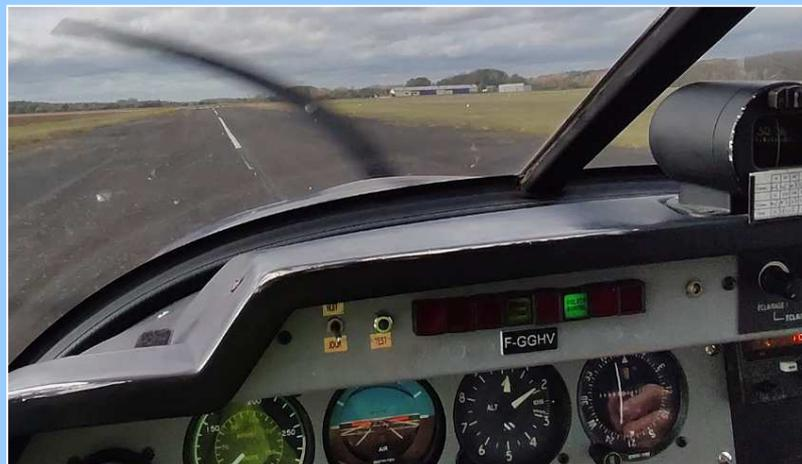
La roue côté vent touche en 1<sup>er</sup>, puis la seconde, on garde l'axe au palonnier, et **on maintient le manche à gauche** (côté vent), en l'amenant **en butée si le vent est fort**.
